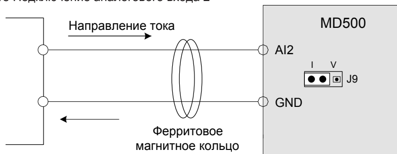
Рисунок 3-18 Подключение аналогового входа 2
